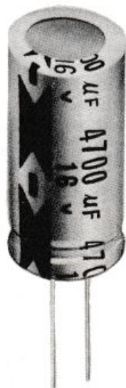
Figura 6. Elettrolitici: meglio abbondare sempre nella tensione di lavoro e attenzione a inserirli in circuito con la giusta polarità...
